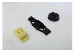
Nous avons sélectionné quelques pièces détachées de train à dupliquer : de haut en bas, roue, flanc de bogie et coupleur de locotracteur.
