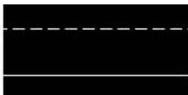
Méthodes de pliage de la tôle : l'image ci-dessus permet de représenter 2 méthodes de pliage : le laiton est entamé sur une face, avec soit une ligne en pointillés, soit une ligne continue. Ces lignes fragilisant la tôle à cet endroit précis, faciliteront le pliage.
